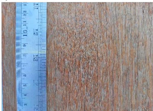
Gambar 2. Retak Permukaan ( Surface Check ) pada Kayu Bangkirai selama Dua Bulan
