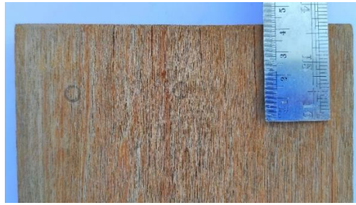
Gambar 3. Pecah Ujung ( End Check ) pada Kayu Kapur
