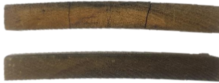
Gambar 4. Kayu mengalami kelengkungan ( Cupping )
